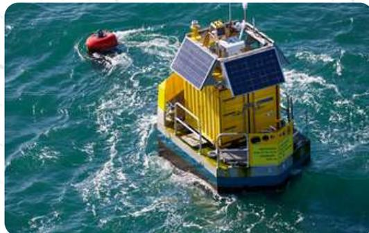
L'entreprise conçoit et commercialise des plateformes et bouées autonomes hybrides qui combinent houle, vent, soleil et courants, intègrent stockage batterie, pilotage intelligent et modules applicatifs. Ces hubs flottants répondent aux besoins de l'industrie pétro-gazière, de la surveillance environnementale, de la décarbonation des data centers, de la défense et des ports.
