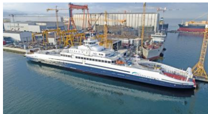
Ferry Bastø électrique OPC 9 MW & 4.8 MWh de batterie
