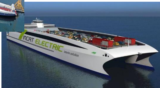
Catamaran électrique d'Incat Batterie 40 MWh
