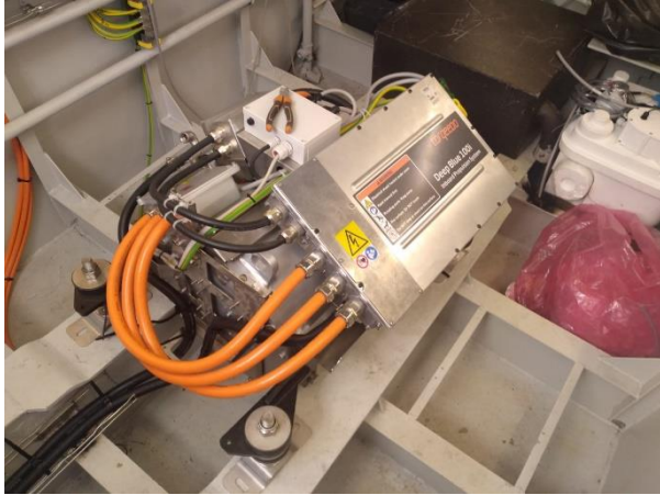
Nouveau moteur électrique de propulsion
