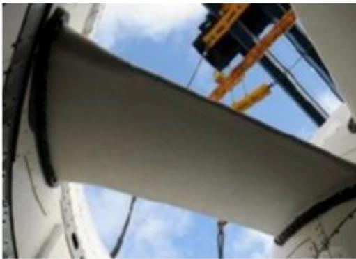
Le projet HYDROFAN consiste à développer une pale d'hydrolienne innovante en composite, produite selon des méthodes industrielles automatisées de placement de fibres et de transfert de résine. L'exploitation de l'énergie hydrolienne va nécessiter à terme l'installation de plusieurs dizaines de milliers de turbines à travers le monde et impliquera donc aux fournisseurs d'hydroliennes d'être capable de proposer des produits à hautes performances, à bas coûts, en très grande série.
