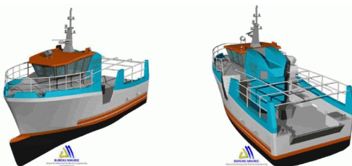
L'objectif du projet FILHyPyNE est de concevoir un bateau de pêche polyvalent (caseyeur, fileyeur?) de 12 m propulsé par un système hydrogène-pile à combustible.
